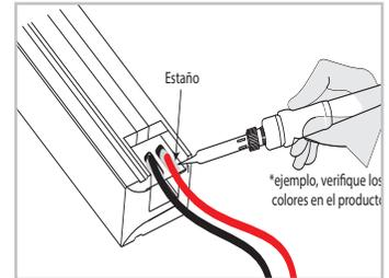
2.3. Usa el cautín para derretir la soldadura de estaño y fijar los cables (Verifica los polos positivo y negativo)
