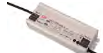
LM320243 Fuente de alimentación 320W, Vin: 100-277 VAC 50-60Hz, Vout: 24VDC, 13.34A, Temp. de Op.: -40 ~90°C, Dimensiones: 252*90*43.8mm, IP67
