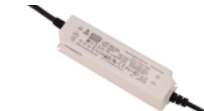
LPF6024 Fuente de alimentación 60W, Vin: 100-277 VAC 50-60Hz, Vout: 24VDC, 2.5A, Temp. de Op.: -40 ~80°C, Dimensiones: 162.5*42.5*32mm, IP67
