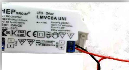
6.- Una vez finalizada la conexión se colocan las tapas de la fuente de alimentación y se atornillan para evitar que el empalme se llegue a safar.
