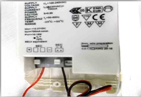
6.- Una vez finalizada la conexión se colocan las tapas de la fuente de alimentación y se atornillan para evitar que el empalme se llegue a safar.
