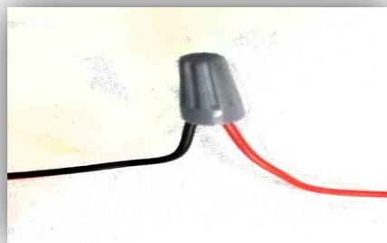
4.- Presionando los conectores de la fuente de alimentación de 700mA (LH70018W), introducir el cable Rojo de la serie al (+) y el cable Negro al (-).
