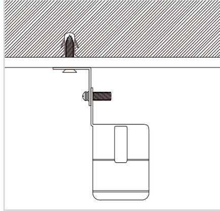
3.2 Se pueden fijar al suelo o al muro según se requiera esto mediante un taquete y una pija en cada clip
