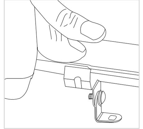
3.3 Una vez fijados los clips a la superficie en donde quedara la luminaria está se montará a presión en los clips.
