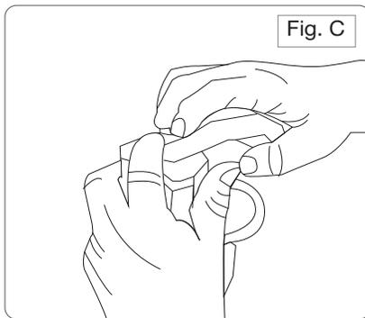
2.2 Sujeta el soporte de forma que la parte hueca se encuentre en la parte superior, coloca la rondana de presión, después el tornillo y finalmente presiona para ajustar la dirección con la llave allen. Este reflector cuenta con una fuente integrada.
