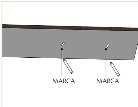
2.1 Hay que presentar el riel en el plafón o muro donde se montará y con ayuda de un lápiz marcar los orificios donde irán los taquetes y con ayuda de un taladro con roto martillo si es necesario barrenar las marcas que se hicieron con el lápiz.
