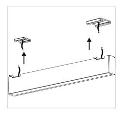
2.4 Realizar la conexion electrica antes de colocar la luminaria. Cuidando que el empalme de los cables se el correcto.
