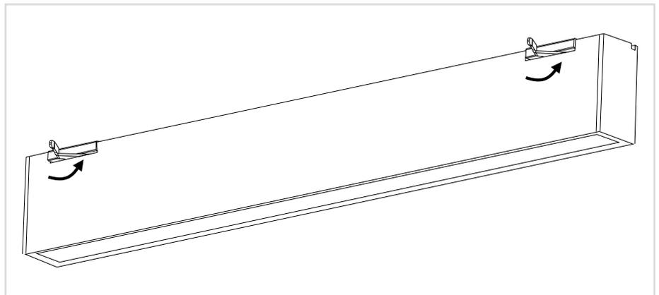
2.5 Colocar la lámpara tomando en cuenta la posición de esta misma con las tapas, ya que si no coinciden las muescas la lámpara no entrara o entrara de forma forzada y puede provocar daño.
