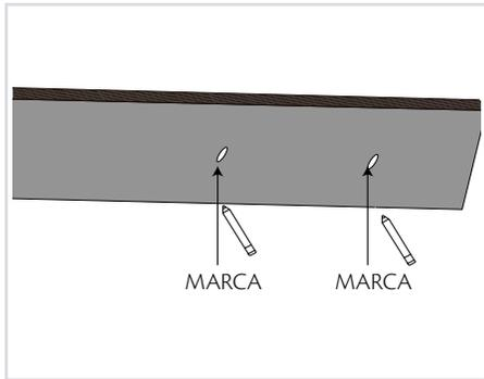
2.1 Hay que presentar las luminaria en el plafón o muro donde se montará y con ayuda de un lápiz marcar lo orificios donde irán los taquetes y con ayuda de un taladro con roto martillo si es necesario barrenar las marcas que se hicieron con el lápiz.
