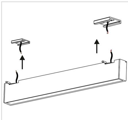
2.4 Realizar la conexión eléctrica antes de colocar la luminaria. Cuidando que el empalme de los cables se el correcto.
