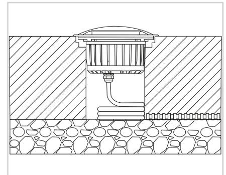
1. Instalar el housing en el suelo, el lado superior debe estar en el mismo nivel que la superficie del suelo, el cable necesita pasar por el housing.
