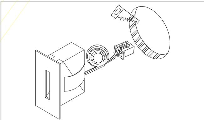
2.1 Para montar en plafón será necesario utilizar un taladro con broca sacabocados (imagen) preferentemente que ronde entre los 39mm y 40mm de diámetro, y realizar la perforación de plafón con dicha broca en el lugar deseado. Cabe mencionar que antes de cerrar el plafón de tabla roca se debió haber dejado la preparación eléctrica de 90-240 V~ para poder conectar a la fuente de alimentación de nuestra lámpara.
