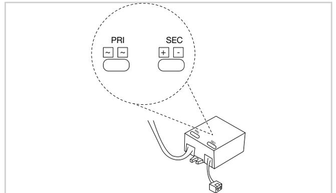
2.2 Sacar por el hueco que se acaba de hacer los cables de alimentación mencionados anteriormente de 90-240 V~ y conectar en los bornes especificados en la fuente (PRI) una vez conectados estos, conectar el cable conector macho (negro y rojo) en los bornes indicados en nuestra fuente (SEC) respetando la polaridad marca en el chasis de la fuente.
