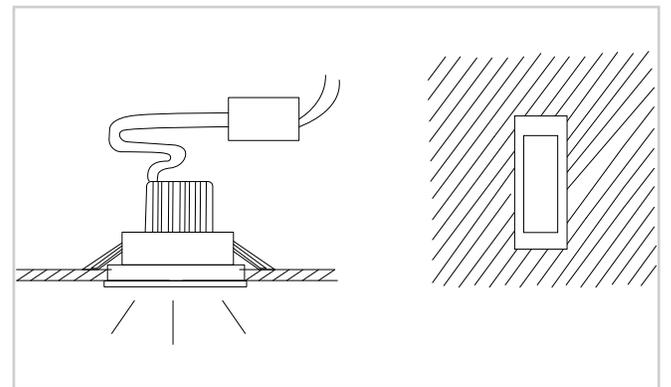
2.3 Conectar el conector macho con el conector hembra de la lámpara y Retroceder las anclas de la lámpara hacia atrás para que estas pasen por el agujero que se hizo anteriormente, esto con ayuda de nuestros dedos índice y pulgar, Asegurar que todo el cable quede dentro del hueco correspondiente e ingresar las anclas de la lámpara al interior una vez que estén dentro las anclas solo se tendrán que soltar y estas colocaran la lámpara por si solas en la posición indicada.
