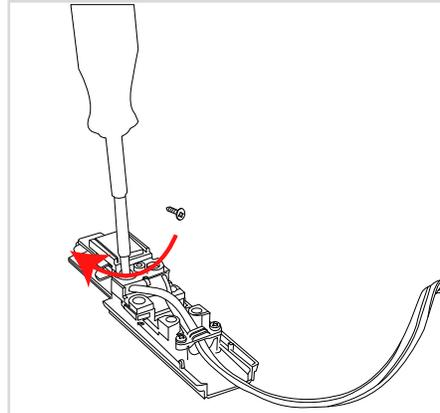
2.5 Con un desarmador gira los tornillos para asegurar la conexión.
