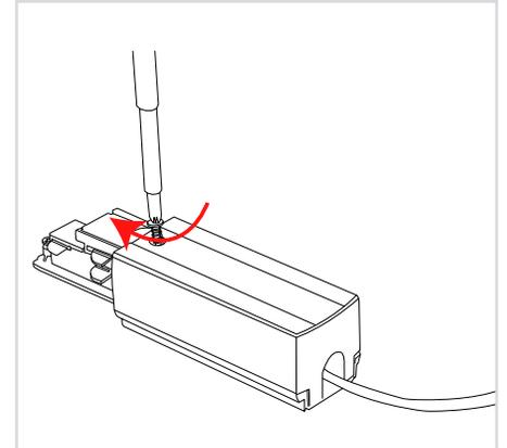
2.6 Coloca nuevamente la tapa del conector, con el desarmador gira el tornillo para afianzar la tapa.
