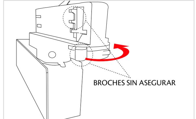
2.10 Girar los broches de seguro de la lámpara para sostener y asegurar la lámpara, es necesario mencionar que estos seguros tienen pines de alimentación y de control de nuestra lámpara. ( 1~10VDC).
