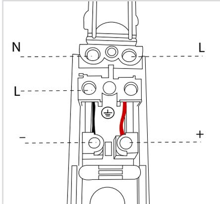
2.4 Quita la tapa del conector con un desarmador para realizar la conexión con el cable AC.
