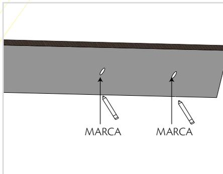
2.1 Hay que presentar el riel en el plafón o muro donde se montará y con ayuda de un lápiz marcar lo orificios donde irán los taquetes y con ayuda de un taladro con roto martillo si es necesario barrenar las marcas que se hicieron con el lápiz.
