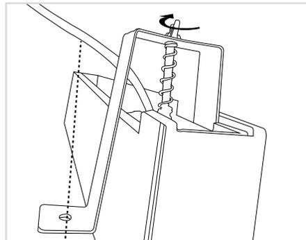
3.2 Este luminario es de altura ajustable. Antes de colocarlo ajustar a la altura deseada.
