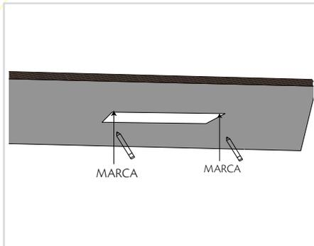
3.1 Hay que presentar las luminaria en el plafón o muro donde se montará y con ayuda de un lápiz marcar lo orificios donde irán los taquetes y con ayuda de un taladro con roto martillo si es necesario barrenar las marcas que se hicieron con el lápiz.
