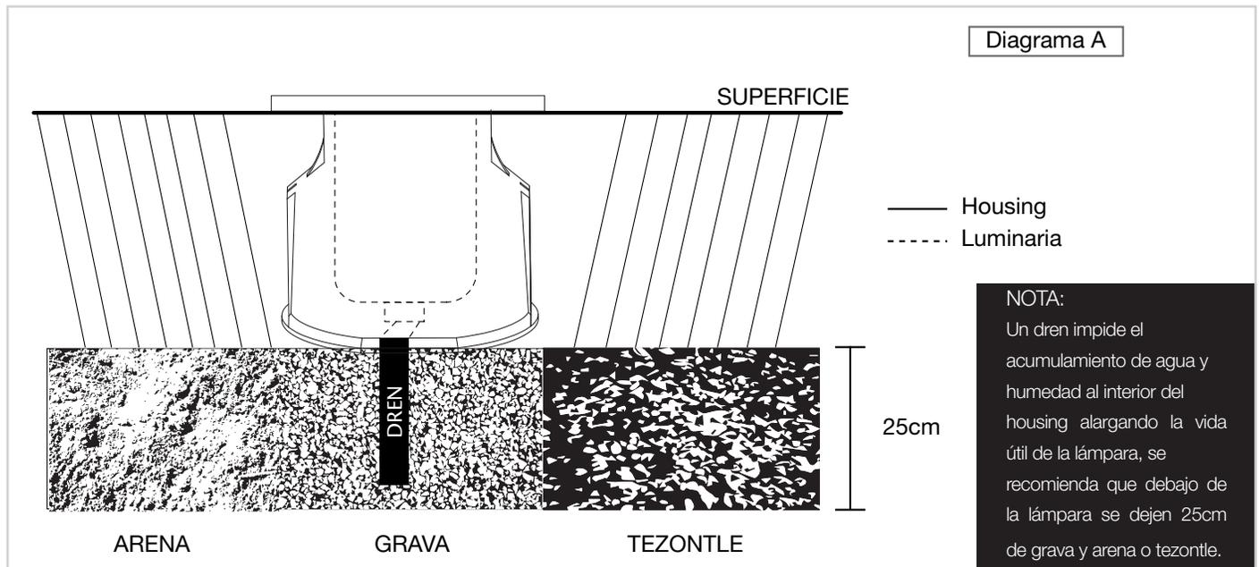
2.2 El housing está hecho de un material que se puede colar en concreto, esto facilitará la fijación permanente de la lámpara al suelo en donde se cuele el housing; es necesario mencionar que la tubería en donde viajará el cable de alimentación llegue perfectamente al housing.
