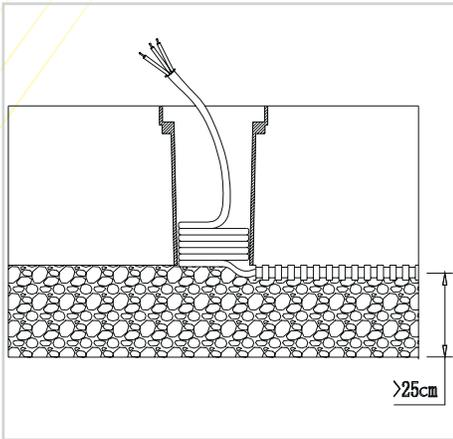
3.1 Instala las mangas de montaje en el suelo. El lado superior debe estar al mismo nivel que la superficie del suelo. El cable debe estar a travez de la manga de montaje.
