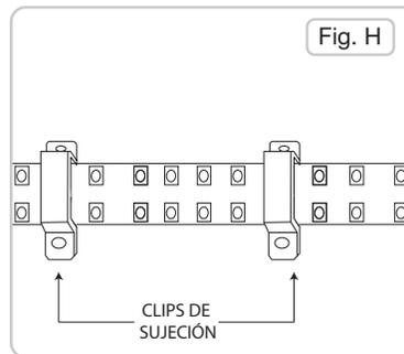
**8.** Colocar el Clip de sujeción dependiendo de qué tan tensa se quiera sujetar la manguera.
