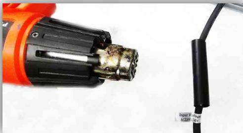
4.- Conectar la manguera con el Mini Controlador identificando su polaridad, en este caso para ambos dispositivos el cable color ROJO (+) y el cable color NEGRO (-). Y cubrir con funda termocontráctil.
