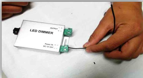
3.- Conectar la manguera al conector del Dimmer manual indicado como OUTPUT respetando la polaridad en la manguera; cable rojo en el (+) y el cable color negro en (-).
