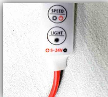
4.- Conectamos el Mini Controlador con la fuente de alimentación de 12VCD estañando con un cautín la puntas y cubriendo el empalme con funda termocontráctil. (Se recomienda utilizar termocontráctil con resina cuando nuestro empalme se encuentre en el exterior).
