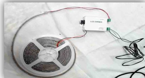
Energizamos nuestra fuente de alimentación con 12VCD, y ahora podremos atenuar nuestra tira de led moviendo la perilla. Siempre se tiene que tener cuidado en la polaridad en la que se conecta si no lo tiene marcado apoyarse con un multímetro.
