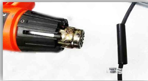
5.- Se realiza el empalme y se cubre con las fundas ya colocadas.
