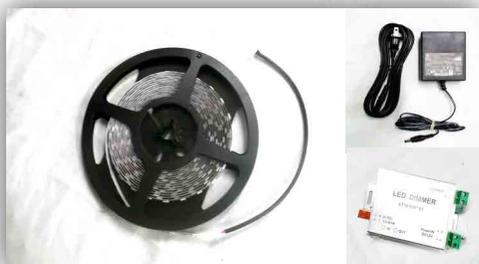
2.- Conectar la Fuente de alimentación de 12VCD identificando la polaridad de esta con ayuda de un multímetro, se unirá al conector de Dimmer manual indicado como de PowerIN DC12V.
