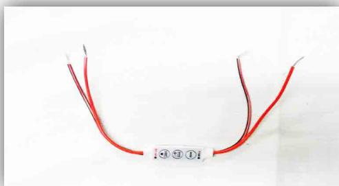
2.- Conectar la tira de Led con el Mini Controlador identificando su polaridad, al igual que la tira de LED, en este caso para ambos dispositivos el cable color ROJO (+) y el cable color NEGRO (-).
