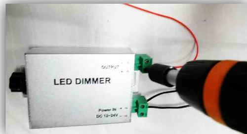
4.- Una vez conectada la manguera a la fuente de alimentación con el Dimmer manual, queda finalizada la conexión.
