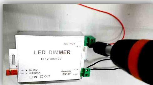
4.- En este caso, en lugar de usar una perilla como en el Dimmer manual, tendremos un conector identificado como: (+)0-10V, (-)≤0.6mA. Esto quiere decir que podemos controlarlo con cualquier Dimmer o sistema que tenga un rango de 0-10V (recomendamos el dimmer de marca Lutron). Se conecta siguiendo el orden: señal positivo(+) y señal negativo (-).
