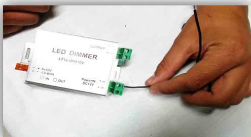
3.- Conectar la manguera al conector del Dimmer manual indicado como OUTPUT respetando la polaridad en la manguera; cable rojo en (+) y el cable color negro en (-).
